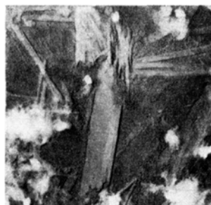
Abb. 2. Bandförmiges basisches Zn-Naphtholgelb. (Die weißen ovalen Körner sind Verunreinigungen von Zinksilikat.)
